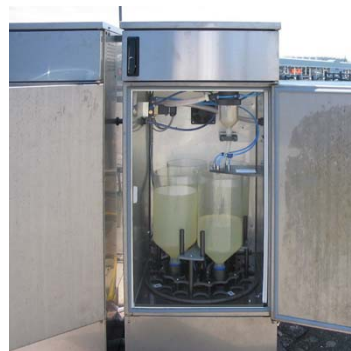
Model WS 316 SE met 4 kolven van 10 liter
