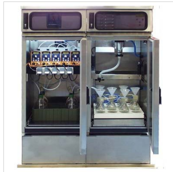
Meetstation met proportionele injectie van conserveringszuur.
