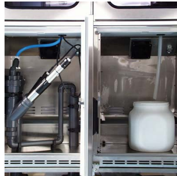
WS 316 meetstation 1x pH sensor en 1x monstername
