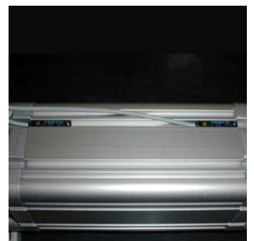
Via readcontacten worden gemiste monsters gedetecteerd.
