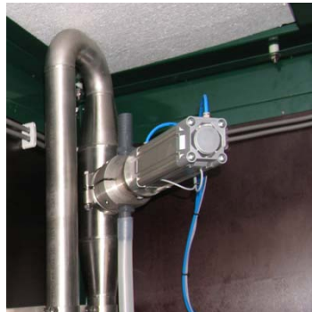
De monsterruiper wordt toegepast vanaf een doorlaat DN40
