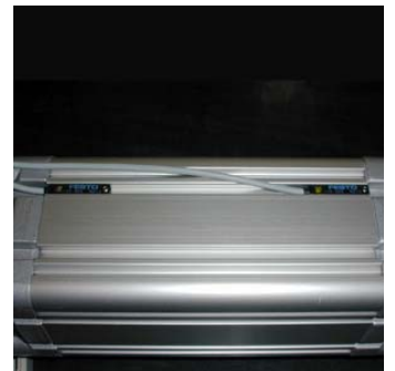
Via readcontacten worden gemiste monsters gedetecteerd.
