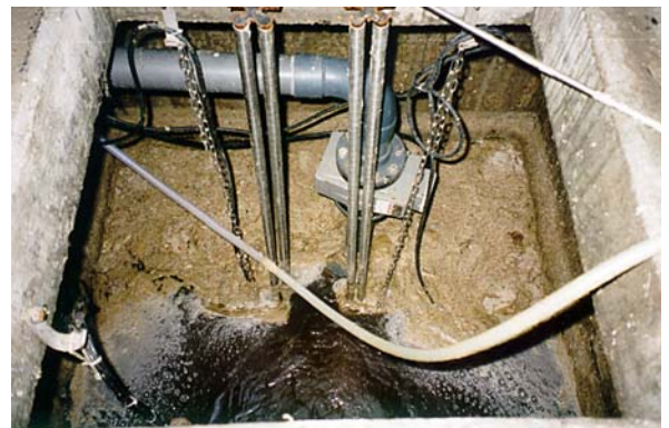
Verre van ideaal: Monsternamen uit een bufferput in een verre van ideaal stromingsprofiel.
