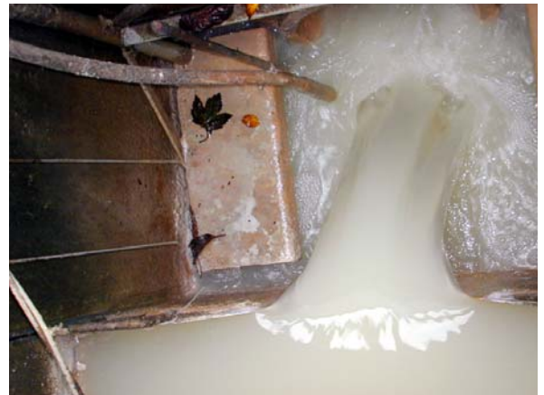
Correct: monsternamen uit een turbulente effluentstroom
