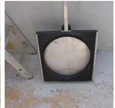
Vlakke plaatafsluiters worden voor en na de meetsectie gemonteerd
