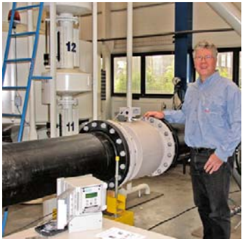
Keuren en kalibreren van het meettraject bij ODS in Barendrecht
