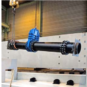
De bypass met verzegelbare afsluiter
