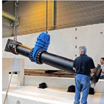
Tijdens de natte kalibratie wordt de EMF vervangen door de dummy
