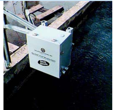
De Slick-Sleuth bestraalt gepulseerd het wateroppervlak met UV-licht. Zodra er een oliedek in de lichtbundel komt zal deze gaan fluoresceren. Er volgt direct een alarm.
