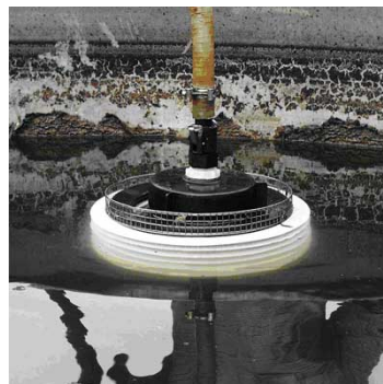
Deze skimmer heeft een slangaan- sluiting aan boven- of onderzijde
