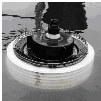
Een skimmer met drijvende rand via harmonicaconstructie
