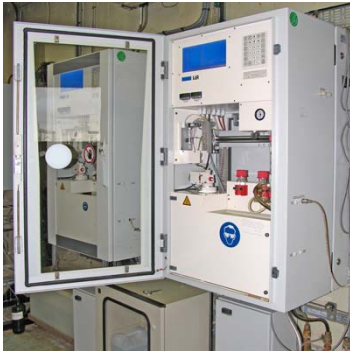
De COD-analyser is goed toegankelijk voor service
