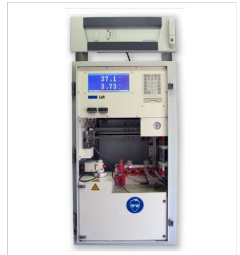
Totaal Stikstof analyser met chemiluminescentie-NOx meetcel.
