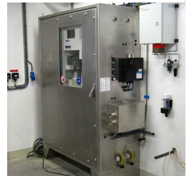
De Quick-COD-o TOD-analyser in een EEx-p behuizing
