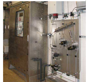
EEx-p behuizing met extern ver- dunningsysteem
