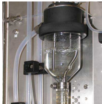
Mixing vessel t.b.v. het mengen van monster en water
