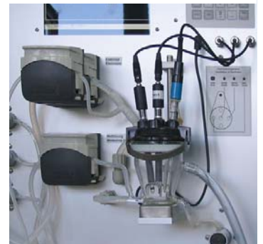
De ELOX-100 werkt met gebruik van elektroden
