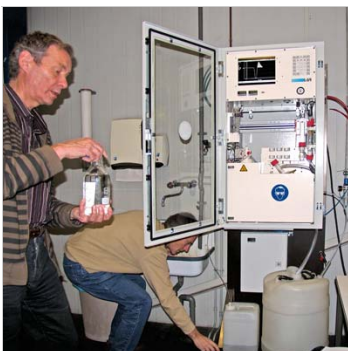
De COD-analyser wordt getest met gebruik van proefmonsters
