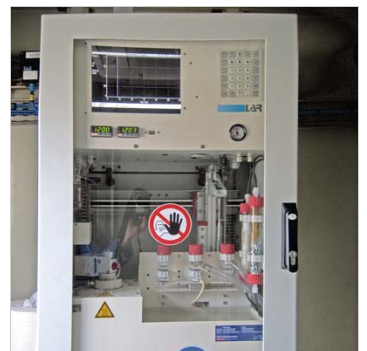
De Quick-COD-o analyser maakt gebruik van een XY-robot
