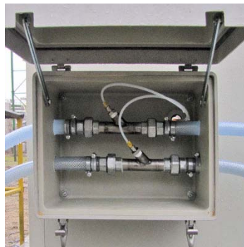
Het sample wordt onttrokken via anti-isokinetische monsternamen
