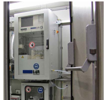
De 2-strooms Quick-TOC-direct analyser meet het TOC-gehalte
