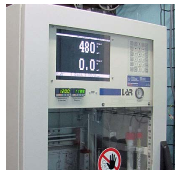
Stroom 1 is bijgeschakeld. Het totaal koolstofgehalte is 480 mg/l
