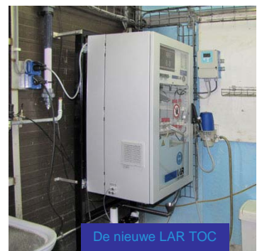
De 2-strooms Quick-TOC TC-only in het analysehuisje
