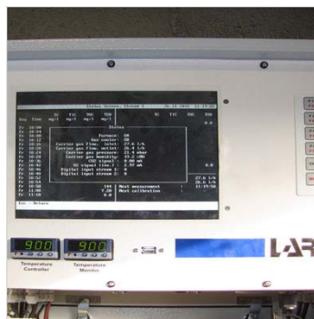
Via het diagnostics scherm wordt de analyser gecontroleerd
