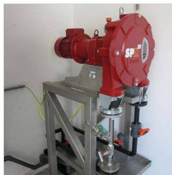
De slangenpomp transporteert het water door een fast sample loop
