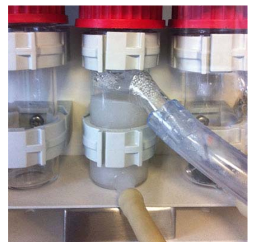
Het monsterdoorstroomvatje met magnetische roerder
