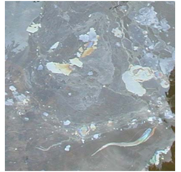
Oliehoudend afvalwater, we zien de zogenaamde vrije olie
