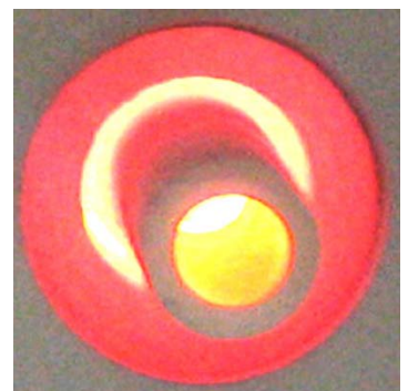
DOC + SOC worden bij 1200 °C volledig geoxideerd
