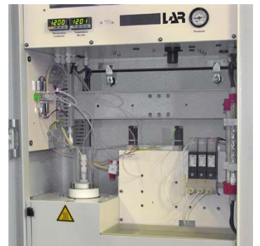
Interieur van de 3-strooms Quick-TOC-purity
