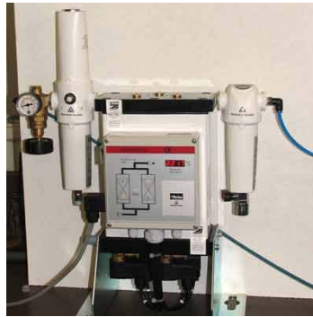
Als dragergas wordt CO2 vrije lucht gebruikt, b.v. via een zero air supply
