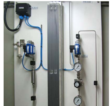
ODS monsterconditioneringssysteem met luchtkoeling
