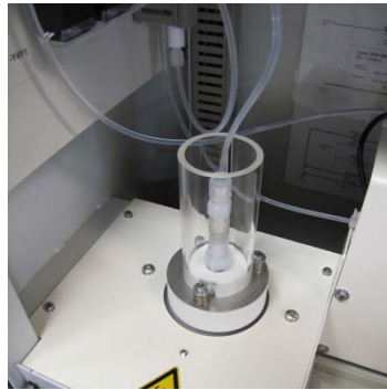
Het monster wordt direct in de 1200 graden Celsius reactor geïnjecteerd
