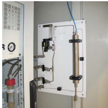
Een door ODS ontworpen monsterconditioneringspaneel
