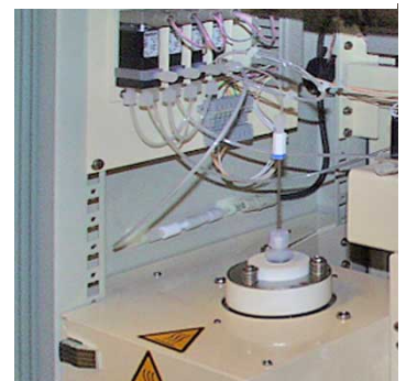
Gesloten multi-injectiesysteem met een vast volume
