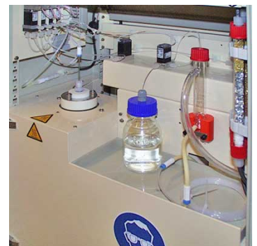
Aansluiting voor een kalibratiestandaard of een "los" plant sample
