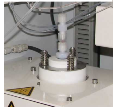
Gesloten injectiesysteem met vaste aansluiting op de injectieaald.
