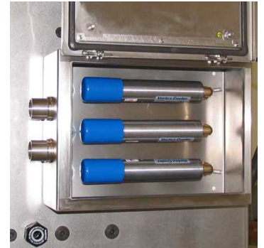
Box met Vortec coolers. Deze worden gevoed met perslucht
