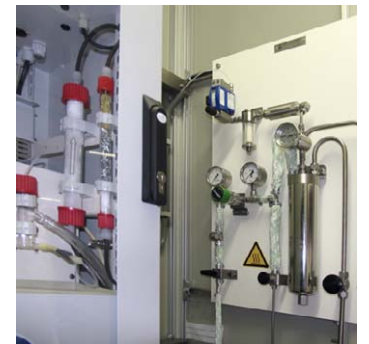
Via monsterconditioning wordt de druk en temperatuur gereduceerd.
