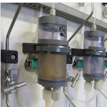
Overflow cup met flowdetectie (niveaudetectie / waterdetectie)
