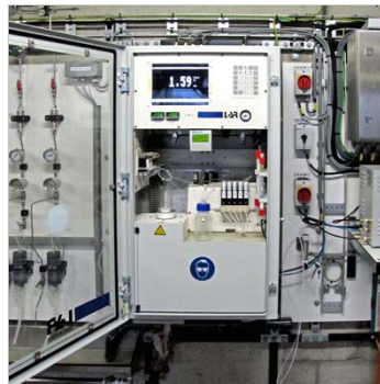
De Quick-TOC-loop TC-analyser met interne stream selector
