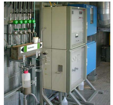
Het werd tijd om de oude Ionics 6800 TOC-analysers te vervangen
