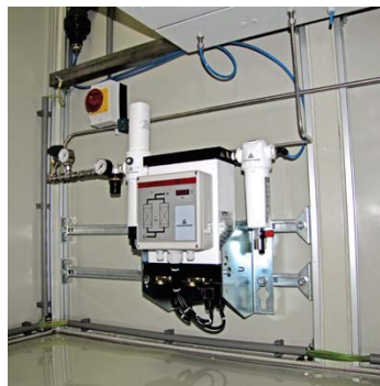
Een zero air supply zorgt voor het CO 2 vrije dragergas
