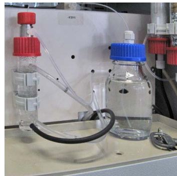
Links: De TIC-reactor Rechts: vaatje t.b.v. het kalibreren
