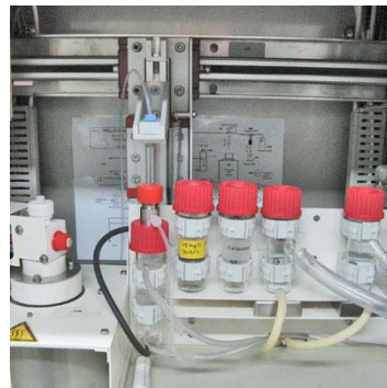
De TIC-reactor (links) en de monstervaatjes met roerder (rechts).
