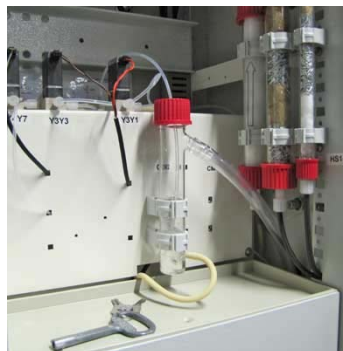
Anorganisch koolstof wordt verwijderd via aanzuren en strippen
