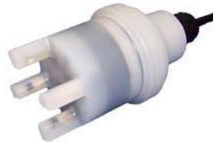
De gepatenteerde sensorconstructie van QuadBeam bevat 2 lichtbronnen en 2 sensoren waardoor 4 meetpaden ontstaan.
