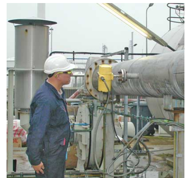
FCI & ODS bepaalt het flowprofiel in een grote luchtleiding
