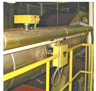
Twee FCI meters in een kanaal van een tabaksproces
