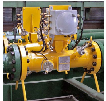
De verladingsmeter is ingebouwd in de testopstelling.
