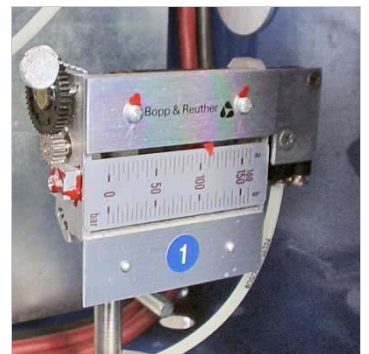
Manocomb schakelaar zonder bourdon-veren & vaan-tuit systeem
