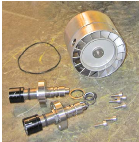
O-ringen van de pulskoppen en de lagers van de rotor / schoepenrad.
